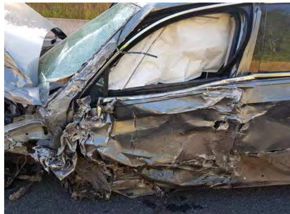
Auslaufende Betriebsmittel mussten gebunden werden und der Tank des VW-Busses war beschädigt, er wurde kurzer Hand ausgebaut damit kein weiteres Benzin auslaufen konnte.
